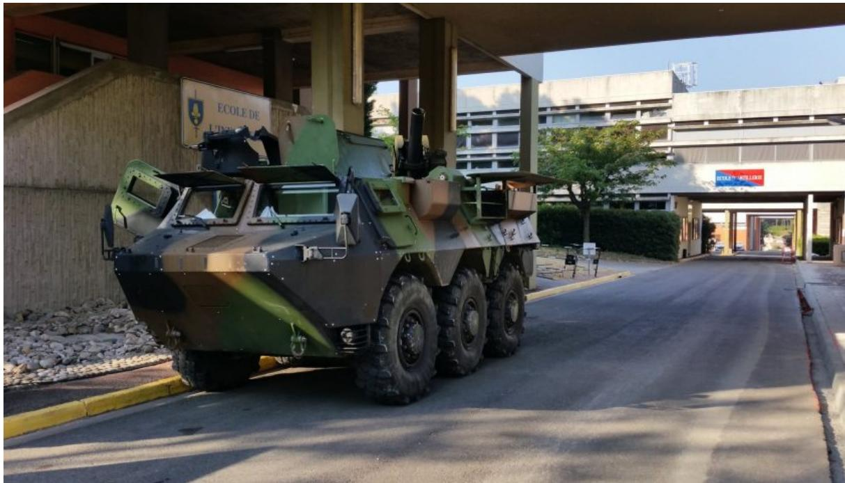
Un VAB 6x6 a été spécialement modifié pour permettre de tester le 2M2R embarqué dans des conditions opérationnelles. Si certains VAB 4x4 avaient été livrés avec un mortier de 81mm, l'Armée de Terre n'opère plus aujourd'hui que des mortiers tractés.
