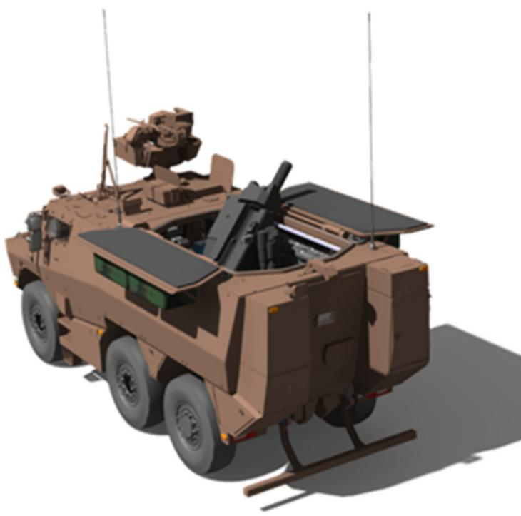
Le système 2R2M est particulièrement compact, son chargement semi-automatisé permettant une mise en œuvre par deux personnes uniquement.
