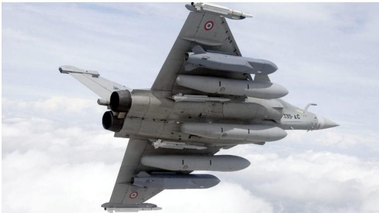
Le missile de croisière SCALP et le système SPECTRA du Rafale lui offre des capacités limitées pour éliminer des défenses aériennes modernes, mais l'absence de missiles anti-radiation et/ou de systèmes de brouillage comme le SPEAR EW en restreignent la portée et la durée.
